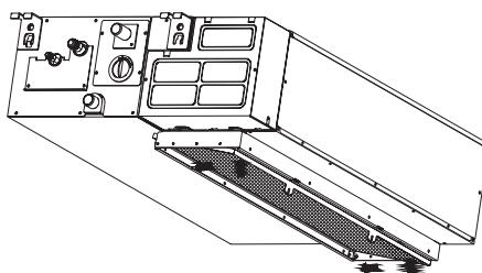
4. Фильтр должен зафиксироваться защёлками воздухозаборного фланца. Установка завершена.
