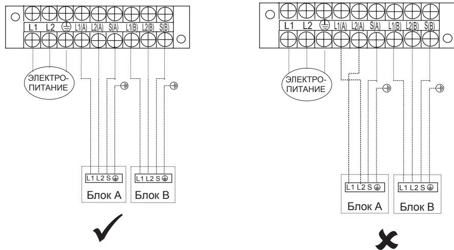
**ПРИМЕЧАНИЕ.** Если клиент хочет выполнить проводку самостоятельно, ему следует руководствоваться приведенными схемами. Основной кабель питания следует пропустить через нижний вывод кабельного зажима.
